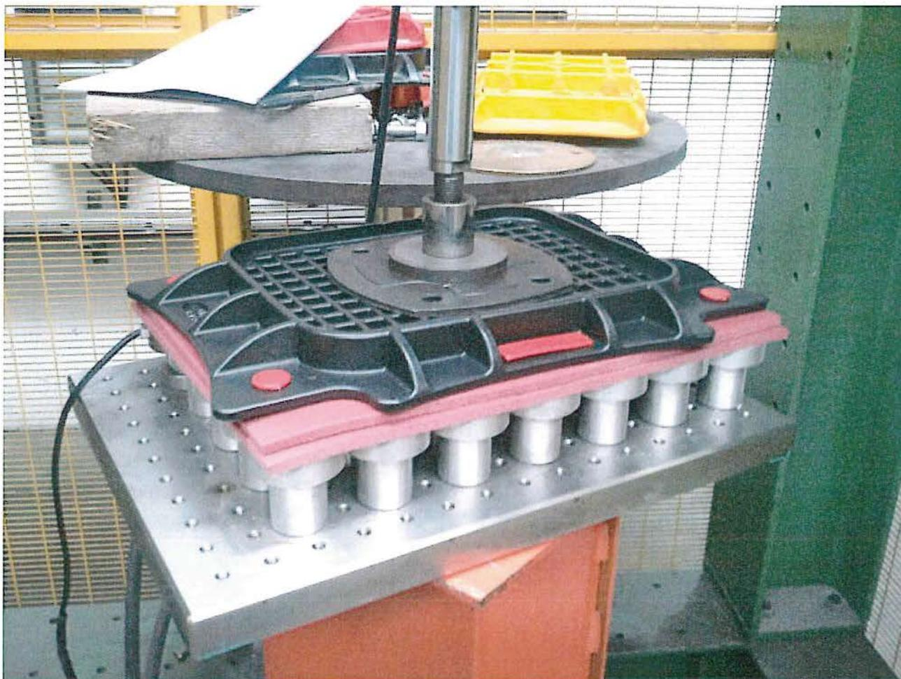
Foto 1 – Prova di resistenza a compressione
