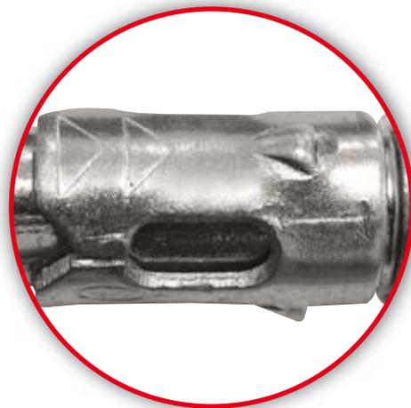
La bugna centrale per ogni segmento della fascetta d'espansione impedisce la rotazione del tassello in fase di serraggio.
