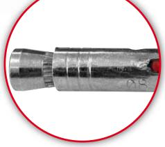
Fascia d'espansione a due settori con scanalature ortogonali nella parte finale per facilitare il bloccaggio all'interno del materiale di supporto durante la fase di serraggio.
